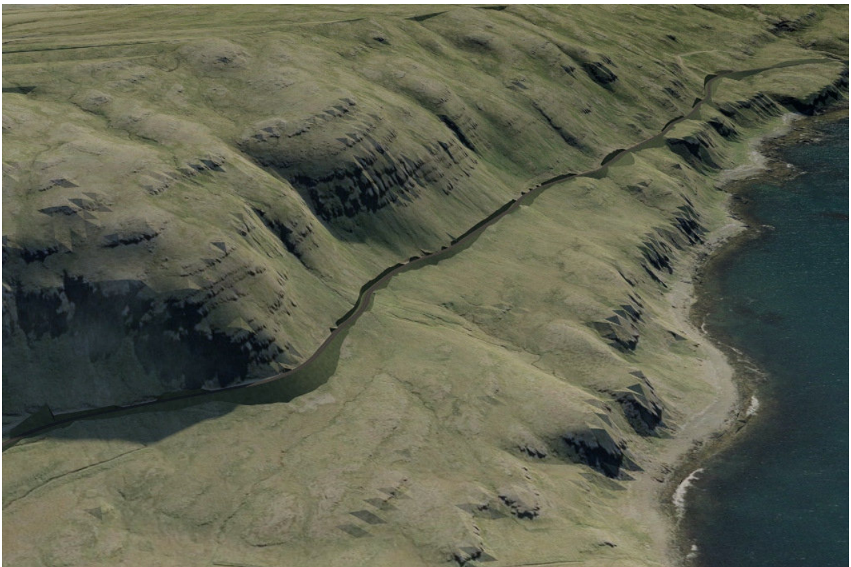
Mynd 7.64 Sama sjónarhorn og að ofan. Vegurinn mun að mestu liggja í eða við núverandi vegstæði fyrir utan tvo kafla og ræsi verður sett yfir Sýrá, efst í hægri horni myndarinnar. Mynd Verkís / Loftmyndagrunnur Loftmyndir ehf.
